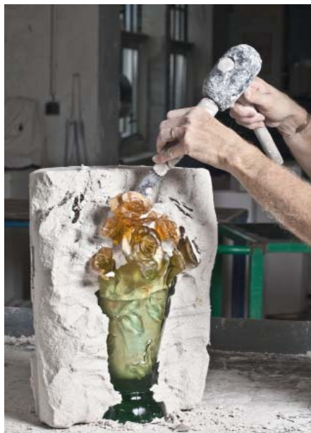
Aujourd'hui, l'entreprise Daum ne fabrique plus que des objets en pâte de verre. © Fonds Daum
