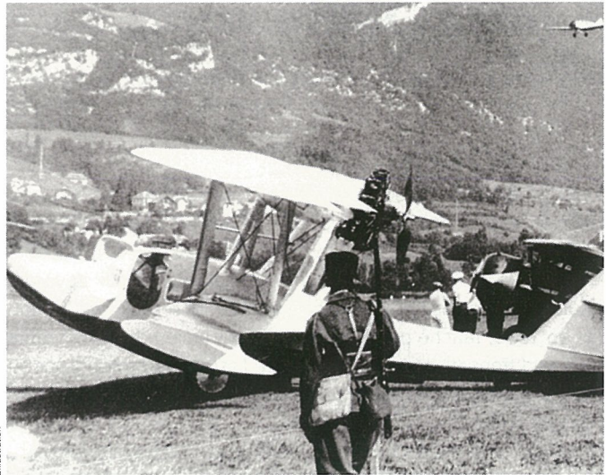
Hydravion Blériot 290 lors d'une revue aérienne. The Blériot 290 seaplane at a military review.
