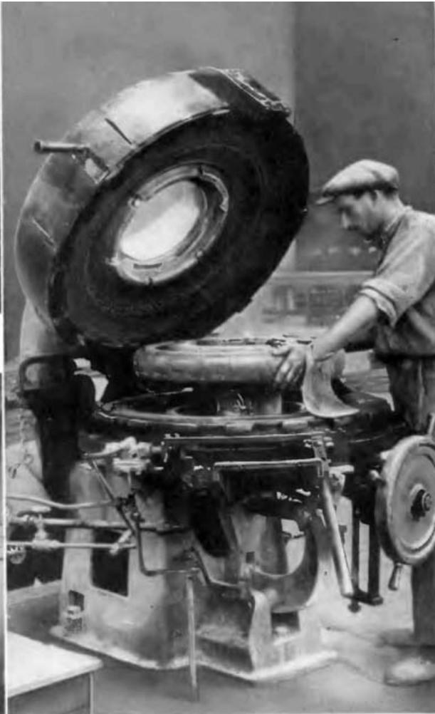
*Mise en autoclave d'une enveloppe de pneumatique, pour cuisson.*
