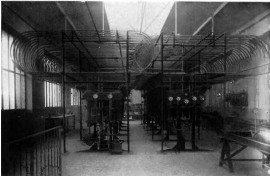
*Banc d'essai représentant un train de 100 véhicules*
