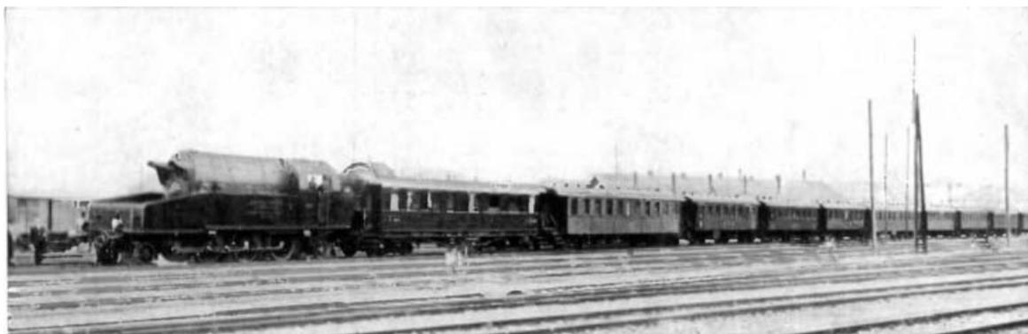
*Locomotive à haute pression avec train d'essai.*
