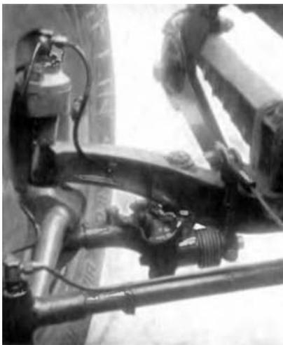
*Application du servo-graissage : toutes les articulations sont graissées d'une manière permanente.*
