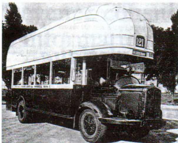
Un autobus à gaz de l'époque avec ballon sur le toit.
